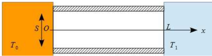
FIGURE 2.7 – Barre calorifugée latéralement en contact avec deux thermostats
