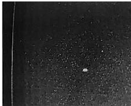
Figure 8 : exemple d'étoile artificielle obtenue en lumière visible par écho laser sur les aérosols de la basse atmosphère à l'observatoire de la Côte d'Azur.
